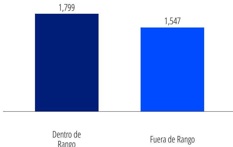
Se registra la cantidad de muestras que cumplen con los parámetros permitidos de cloro residual en los sistemas de agua potable durante el año 2023 por municipio. La vigilancia se realiza mediante muestreos periódicos en distintos puntos de los sistemas, y los resultados se comparan con los parámetros establecidos de cloro residual según la Norma COGUANOR NTG 29001 (0.5 mg/L - 1.0 mg/L). Esta información es clave para garantizar el suministro de agua segura para el consumo humano.
